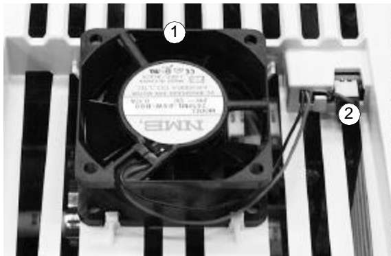
拆下前盖，风机顶部。
